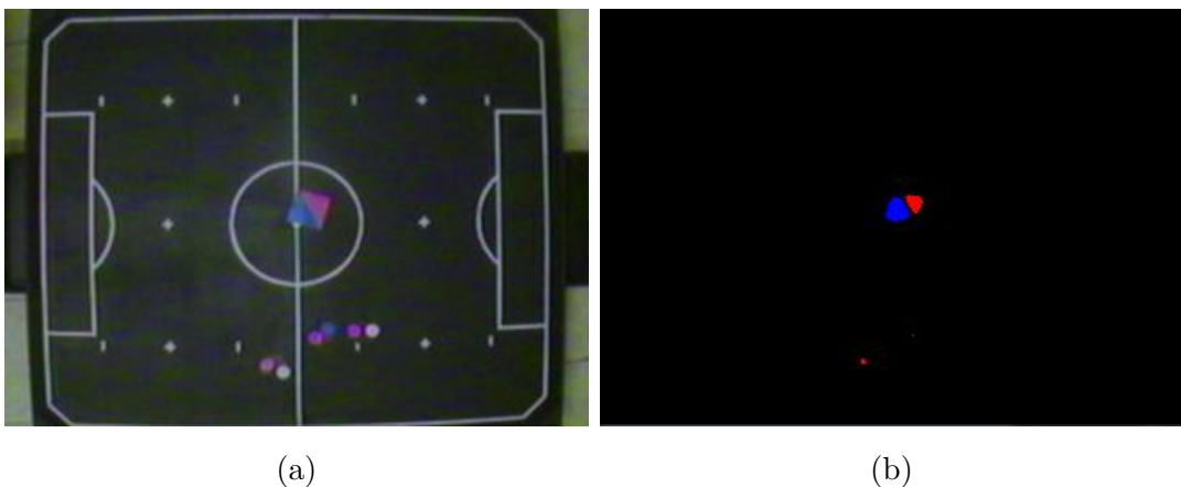
Figura 21: (a) imagem antes da classificação dos pixels. (b) imagem depois da classificação dos pixels.
