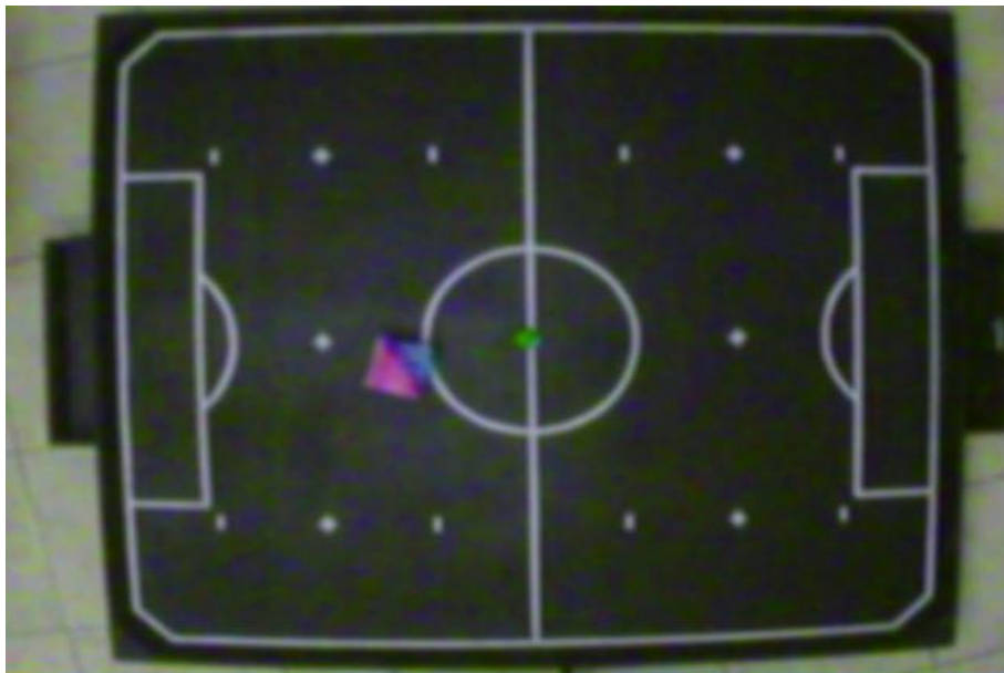
Figura 30: Transformação de cores pela matriz de calibração.
