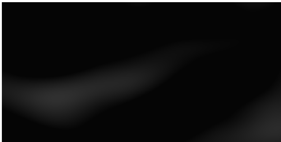
Figura 26: Mapa de alturas gerado com a função ruído de Perlin com: frequência = 0.01, seed = 1234 , escala = 1.
