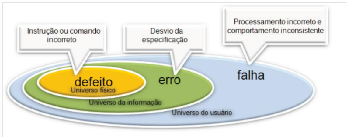
Figura 2.1: Exemplifica a relação entre os conceitos de Defeito x Erro x Falha em teste de software
