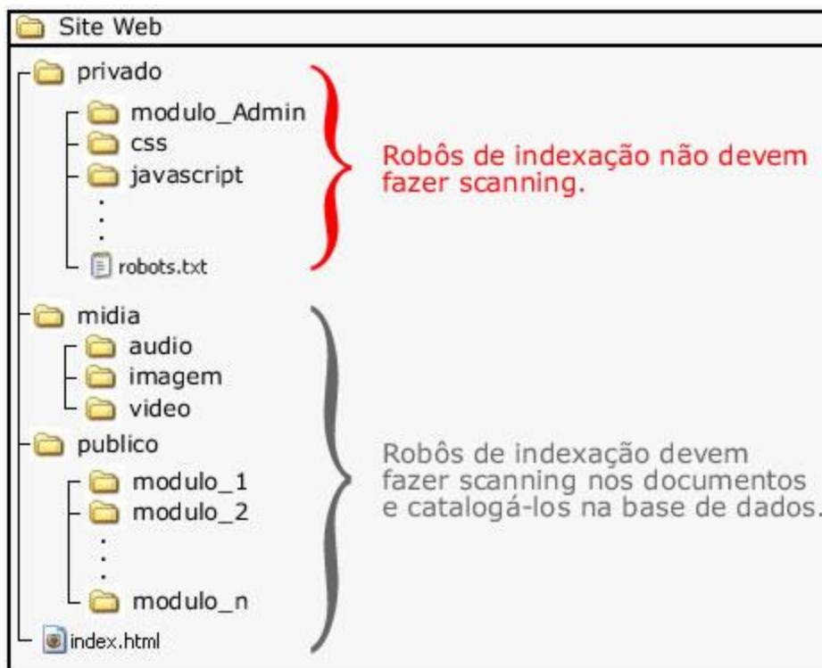
Figura 2-17 Hierarquia de diretórios com bloqueio a robôs de indexação
