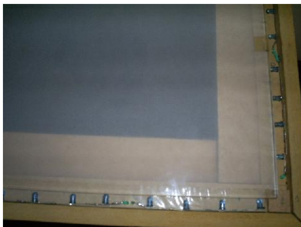
Figura 5.1.1 Posicionamento dos leds e do acrílico.
