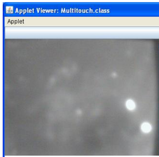
Figura 5.2.2 Imagem da câmera com dois pontos de toque.
