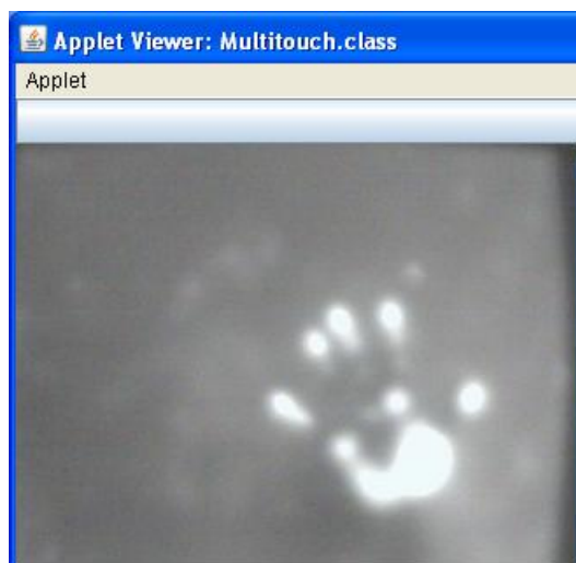
Figura 5.2.4 Imagem da câmera com pontos de toque variados.
